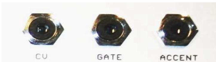
Über die Buchsen CV Out, Gate Out und Accent Out (3,5 mm) lassen sich die Module im Rack in dem typischen 303-Timing ansteuern.
