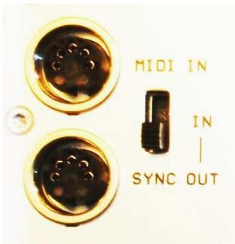
An der Sync Buchse wird dann ein Sync Out Signal für andere Geräte mit Sync In Eingang ausgegeben.
